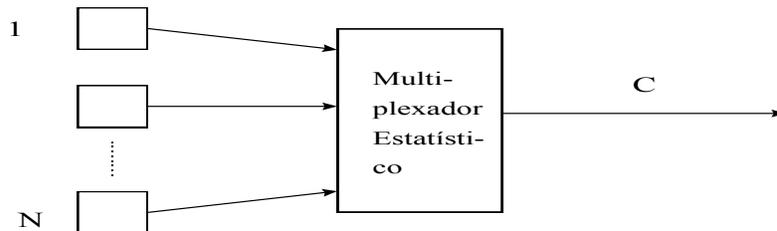
A capacidade  $C$  da linha é 1200 bps e o comprimento médio da mensagem é 100 bits. Cada terminal gera mensagens aleatoriamente a uma taxa de 0,1 mensagens/seg. As mensagens (pacotes) são armazenadas em um único buffer de capacidade infinita e são transmitidas no esquema FIFO. Se as mensagens têm comprimentos aleatórios,
