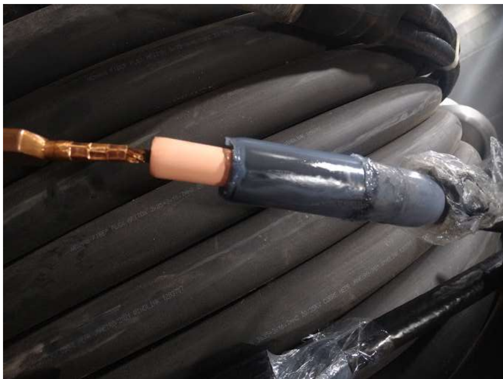
Figura 2 - Cabo monopolar reprovado no ensaio de DPs. (Fonte: Foto Autoral)
