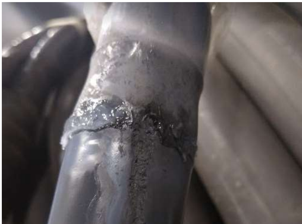
Figura 3 - Camada externa danificada do cabo monopolar. (Fonte: Foto Autoral)
